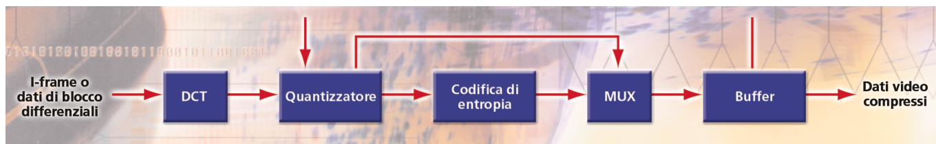
▲ Figura 3: dopo la stima di movimento per i P-frame e i B-frame, i macroblocchi di ogni frame vengono portati dalla DCT nel dominio delle frequenze. Il quantizzatore riduce poi il numero di bit usati per descrivere i dati di frequenza. La codifica di entropia ordina i dati quantizzati per consentire una compressione ulteriore. Il buffer mantiene i parametri di quantizzazione, in modo da poterli inserire nelle informazioni di header del blocco MPEG finale
